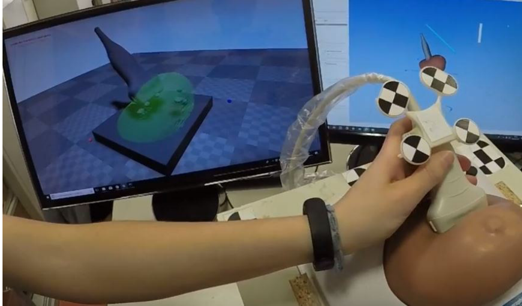
Figura 2.5: Nello schermo a sinistra simulazione del phantom anatomico del seno
