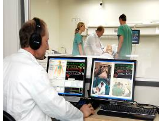
Simulatore paziente controllato dal computer disposto in una sala regia. Di solito il vetro è a visione monodirezionale
