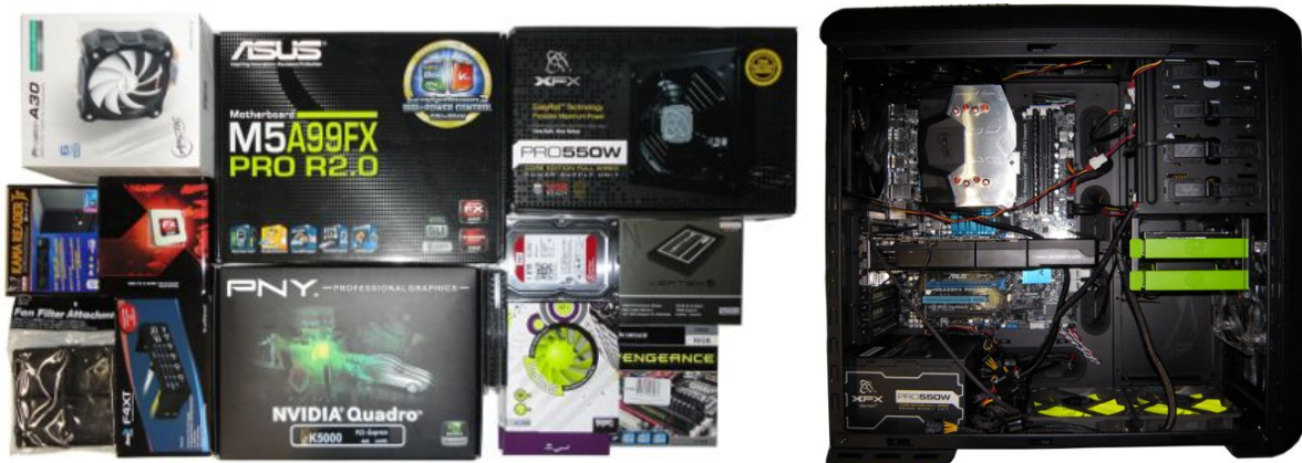
Figura 3 - La workstation di controllo, interamente basata su componentistica COTS, combina le funzionalità multi-display avanzate dell'architettura GPU NVIDIA ® Kepler con la tecnologia NVIDIA ® 3D Vision ® per gestire autonomamente l'intero VE.
